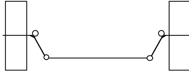
Figura 2.1: Mecanismo de Ackerman.
