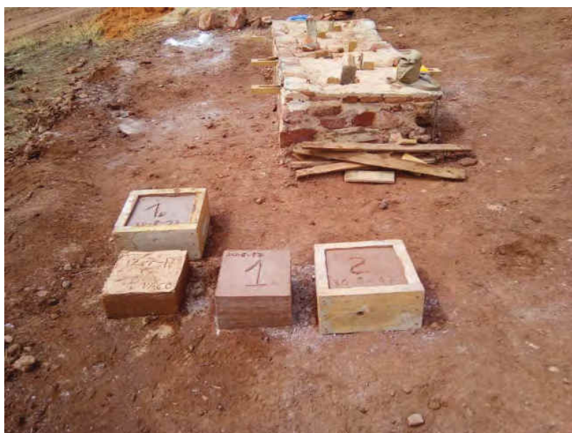
Figura 15. Muestras de tapia con distintas dosificaciones, previas a la ejecución del muro experimental (fuente: D. Gallego)
