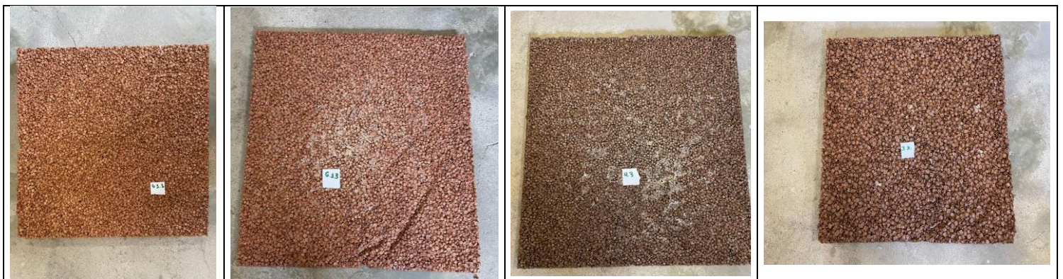
Figura 15. Ejemplos de losetas fabricadas con material base LDPE reciclado de residuos agrícolas
