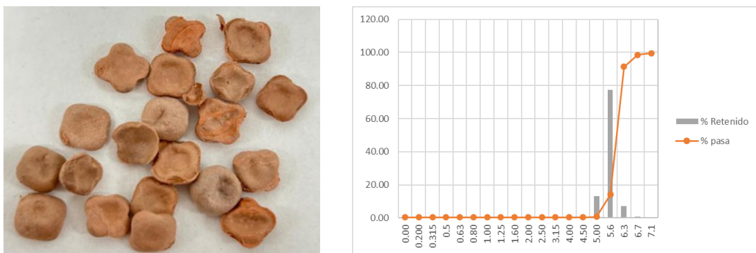
Figura 14. Muestra de granulado de LDPE reciclado y granulometría base para relleno técnico
