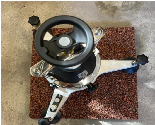
Figura 16. Ejemplo de toma de datos. La absorción de impactos, deformación vertical y energía de restitución se evalúan mediante el atleta artificial avanzado (AAA). La altura de caída crítica se evalúa mediante el Head Injury Criterion (HIC).
