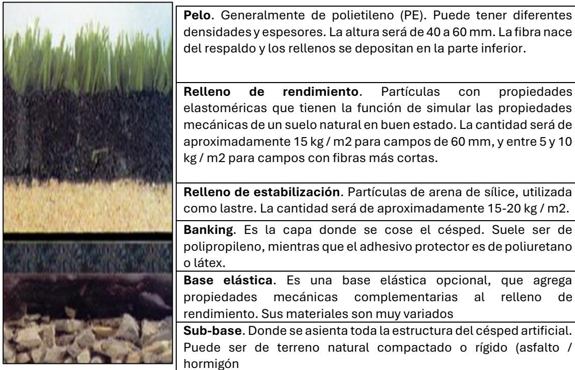
Figura 1. Componentes de césped artificial deportivo de tercera generación
