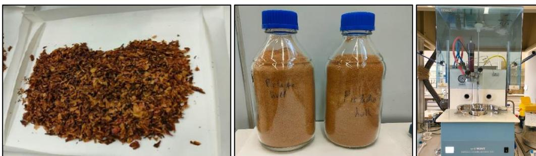
**Figura 1.** Cáscara verde de pistacho (CVP) tras proceso de secado (izquierda); secado + molienda (centro); y reactor microondas utilizado para MA-SWE (derecha).
