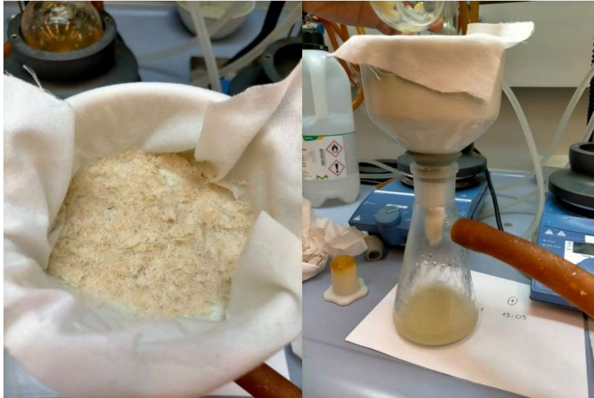
Figura 10. Separación de los residuos de pelo mediante filtración. La turbidez de las aguas madres corresponde a la presencia de queratina solubilizada.
