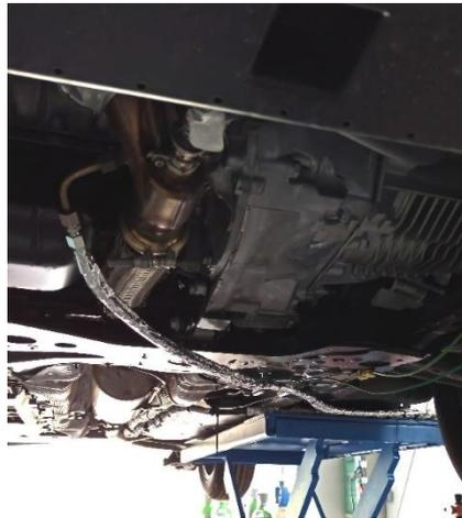
Figura 3.15 Conexión para extraer el flujo de muestra
