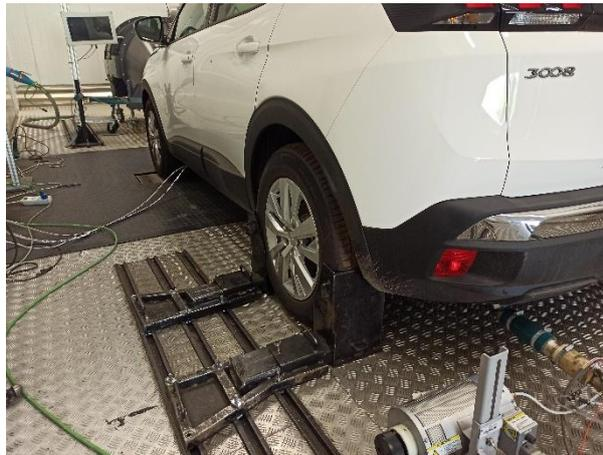
*Figura 3.7 Vehículo situado sobre los rodillos y anclado*
