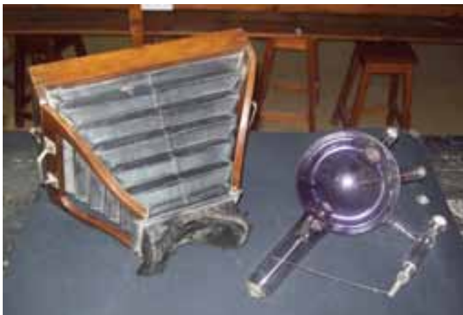
Fig. 3. Ampolla de rayos X y pantalla fluorescente empleados en la realización de radiografías con el aparato de Sánchez.
