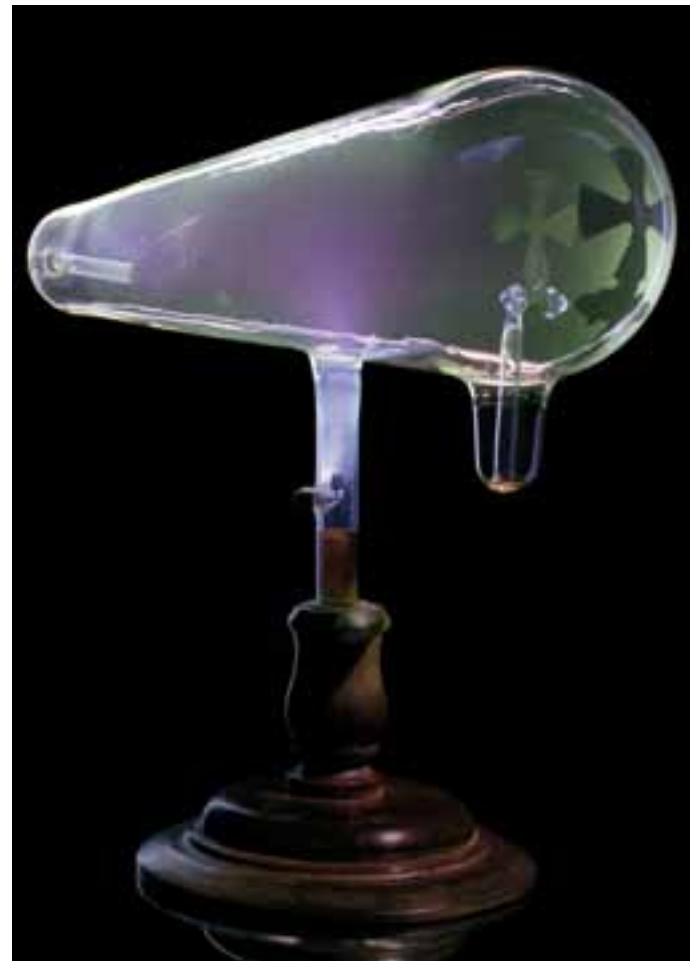
Fig. 7. Experimento clásico de la cruz de Malta para mostrar la propagación rectilínea de los rayos catódicos. Tubo de descarga perteneciente al legado de Mónico Sánchez que se conserva en el MUNCYT. Fotografía de Yolanda Villaverde y Jesús González de la Lastra, realizada por encargo de la FECYT.
