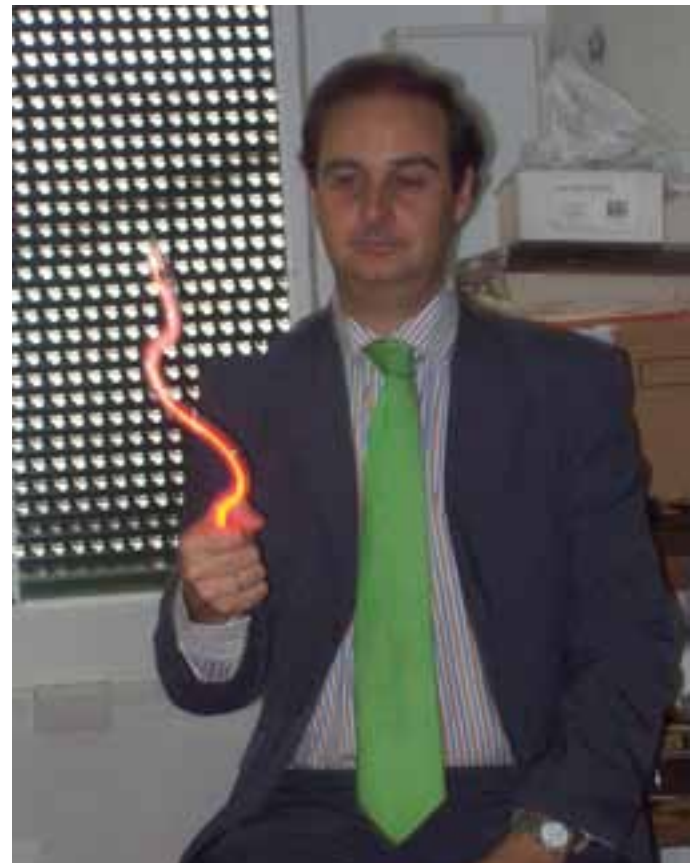
Fig. 8. Tubo de neón encendido por efecto de la corriente de alta frecuencia transmitida por el cuerpo humano sin daño.
