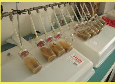
Incubación de muestras de sedimentos para la medida del potencial de desnitrificación (fase de desoxigenación).
